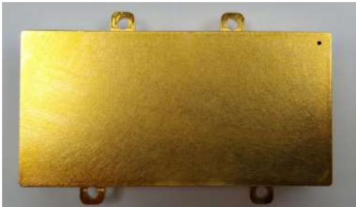
直流-直流轉換器 20V 至 70V, 28Vo 112W
